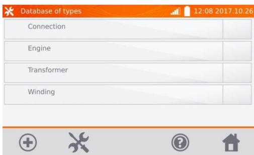
O instrumento é fornecido com 4 tipos de equipamentos já gravados na memória. Usar o botão **+** para adicionar um novo tipo de equipamento na lista.
